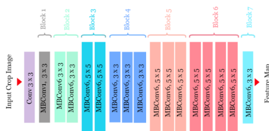
Gambar 2. Arsitektur EfficientNetB0 (Raihan et al., 2023)
