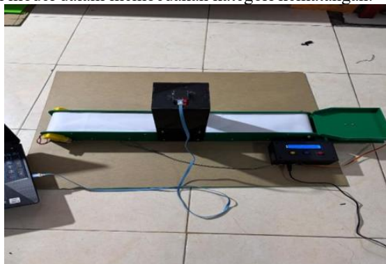
Gambar 1. Prototipe Sistem Sortir Otomatis
